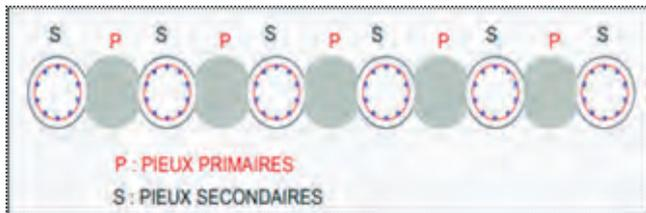
Ce système de soutènement comprend deux types de pieux réalisés avec un phasage déterminé :
