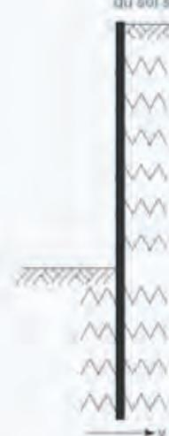
b) : courbe de réaction du sol sur l'écran en un point donné
